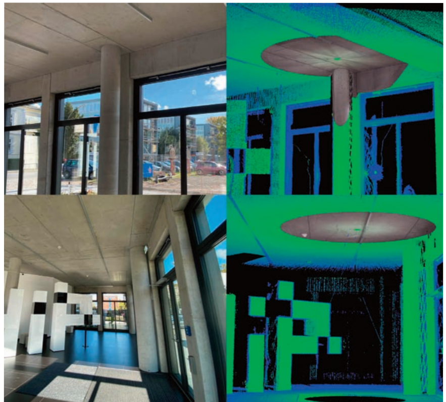
Bild 1 | Kernstück des 3D-Laserscanners PLX+ ist ein LiDAR-Sensor, der Zielobjekte mit dem Pulslaufzeit-Verfahren scannt. Zudem hat das System eine integrierte Farbkamera, die zusätzlich die Farben des Zielobjekts erfasst.
