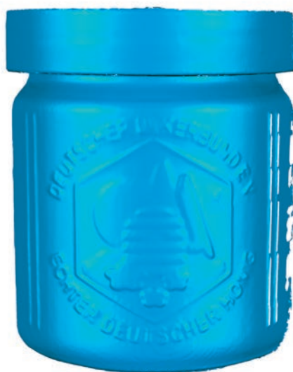
Bild 1 | 3D-Aufnahme einer Parfümflasche (o.). In unter 1s wurde ein intensiver thermischer Streifen in Schritten zu 0,7mm über das Objekt bewegt und 99 Bilder aufgenommen. Der Glasbehälter (u.) wurde in 5s in Schritten zu 0,2mm und mit 500 Bildern aufgenommen.
