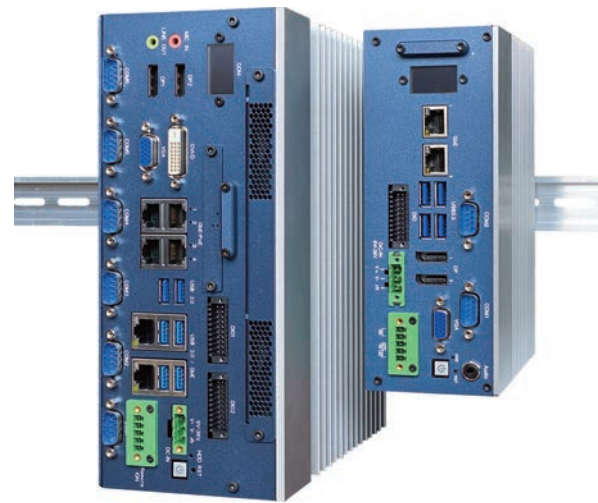
Bild 2 | Die Hutschienenvarianten AIMD und AIHD der Eagle-Eyes-IPC-Serie von Efco haben alle Schnittstellen sowie die Zugänge zu den Batterie- und Festplattenfächern auf der Frontseite.
