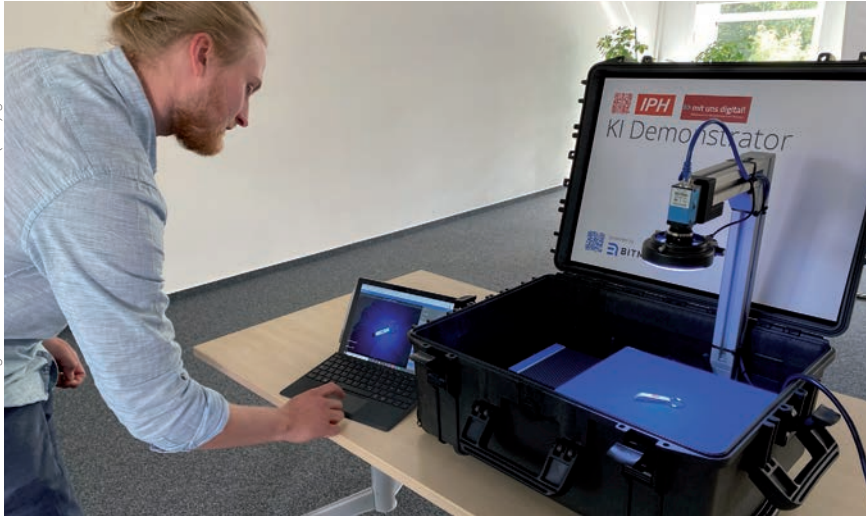
Bild 2 | Der KPI-Assistant mit integrierter KI-Vision-Anwendung und einer 3,1MP Farbkamera als mobile Inspektionslösung.
